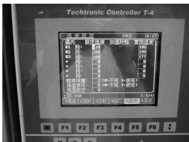
如果注塑机开始注塑工作的时候，一定要开机，打开电热开关，预热一个小时左右的时间，等到设定温度和实际温度相差不多（一般为 3~5℃）的时候方可开始注塑。
