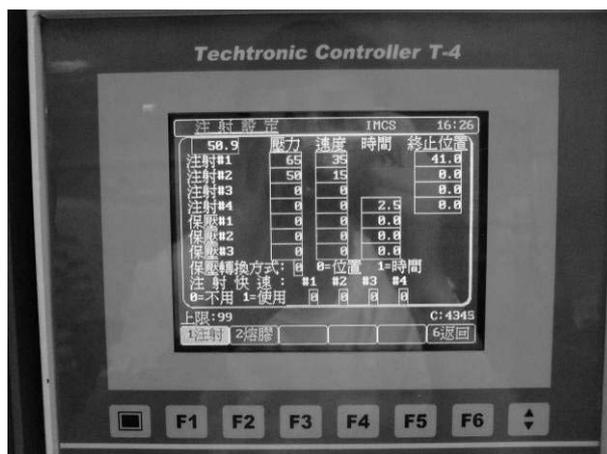
(5) 熔胶/倒索/冷却参数设定
