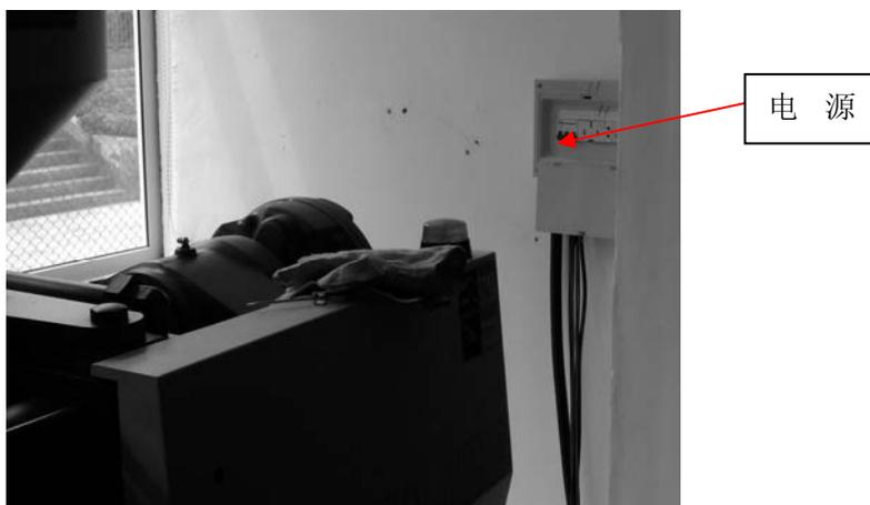
2. 打开注塑机电源总开关。
