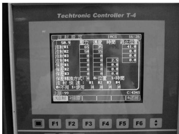
(5) 熔胶/倒索/冷却参数设定
