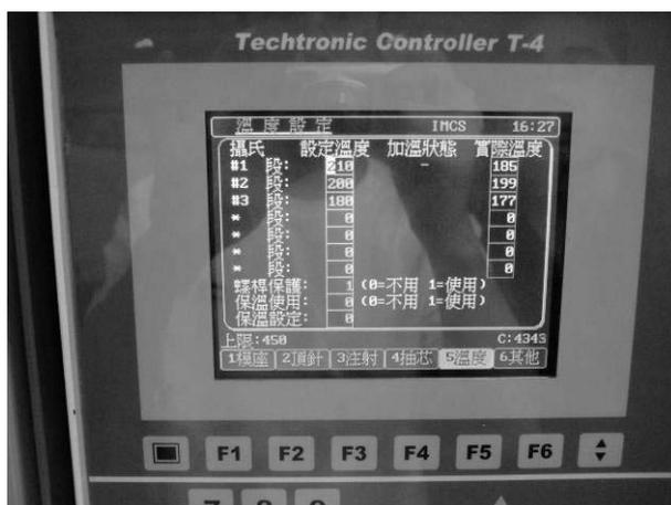
如果注塑机开始注塑工作的时候，一定要先检查料斗是否有料，同时打开电热开关键，预热一个小时左右的时间，等到设定温度和实际温度相差不多（一般为 3~5℃）的时候方可开始注塑。相关资料中下表所示。
