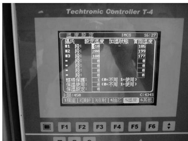
如果注塑机开始注塑工作的时候，一定要开机，打开电热开关键，预热一个小时候左右的时间，等到设定温度和实际温度相差不多（一般为3~5℃）的时候方可开始注塑。
