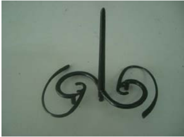
图 1-66 单排列式分流道实例照片
