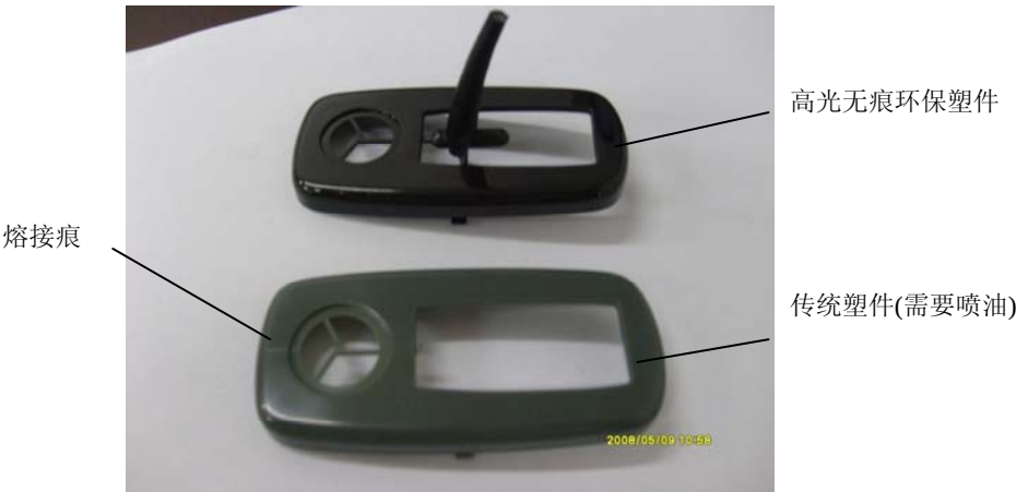
图 1-50 高光无痕塑件与传统塑件的对比
